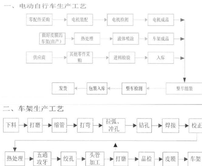
图 1 生产工艺流程图示意图
